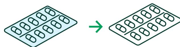
EMBALLAGE-COQUE « BLISTER » EN PVC-ALUMINIUM → EMBALLAGE-COQUE « BLISTER » EN MONO-PE, MONO-PET OU MONO-PP
